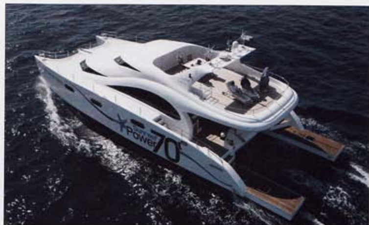
Le Sunreef 70 Power est le premier de la série. Laurent y a adjoint des jupes pour pouvoir allonger la flottaison.
